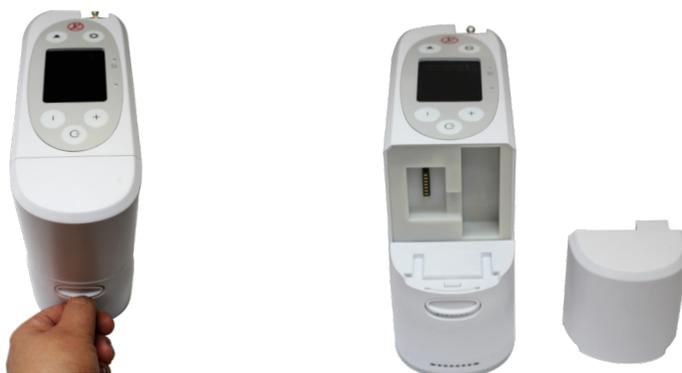
Introduzca la batería Mini Mercury deslizándola en el alojamiento, con la posición correcta la traba se bloquea y fija correctamente la batería.
